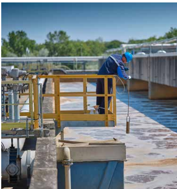
Probenahme im Belebungsbecken der Zentralen Kläranlage Schkopau, 2019
